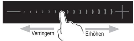
**i** Wenn Sie innerhalb von 1 Minute keine Leistungsstufe wählen, schaltet sich das Induktionskochfeld automatisch wieder aus. Sie müssen das Gerät dann erst wieder einschalten, um es zu nutzen.
